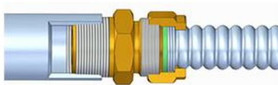
Ejemplo de conexión entre el tubo CATS y un tubo convencional con pieza reductora.
